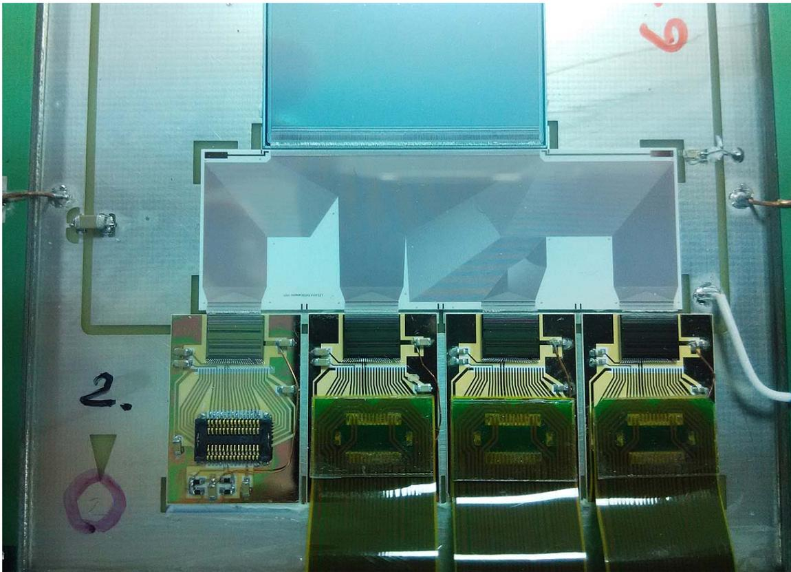
Рис. 2. Фотография части сборки, на которой видны (сверху вниз): часть детектора с разваркой на адаптер, соединение адаптера с ASIC, ситалловые микроплаты с ASIC и SMD разъёмы для подсоединения к печатной плате электроники, гибкая плата из фольгированного полиимида с SMD разъёмами.
