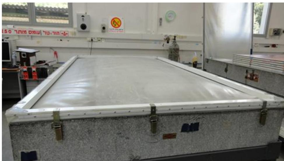
Рисунок 3 - Прецизионный гранитный стол, закрытый вакуумной пленкой из-под которой откачивается воздух.
