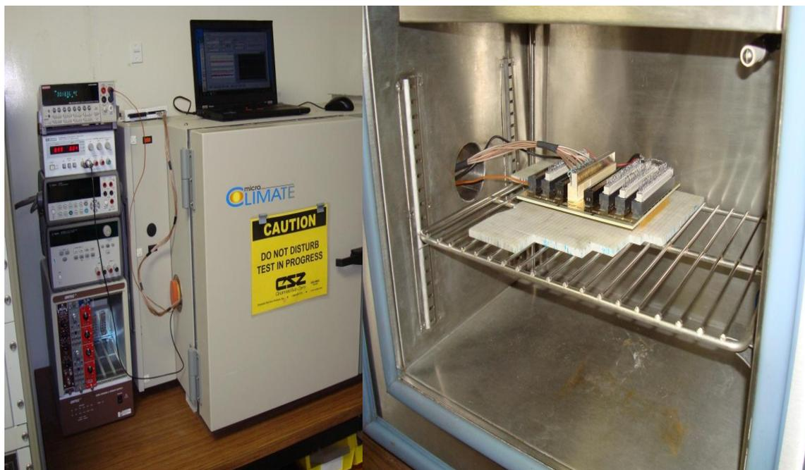
Рисунок 34 - Проведение измерений температурных циклов образцов базовой платы ЖАК (ТРИУМФ, Канада). Слева – измерительный стенд управляемый первой версией программы контроля и мониторинга. Справа – образец базовой платы в температурной камере.
