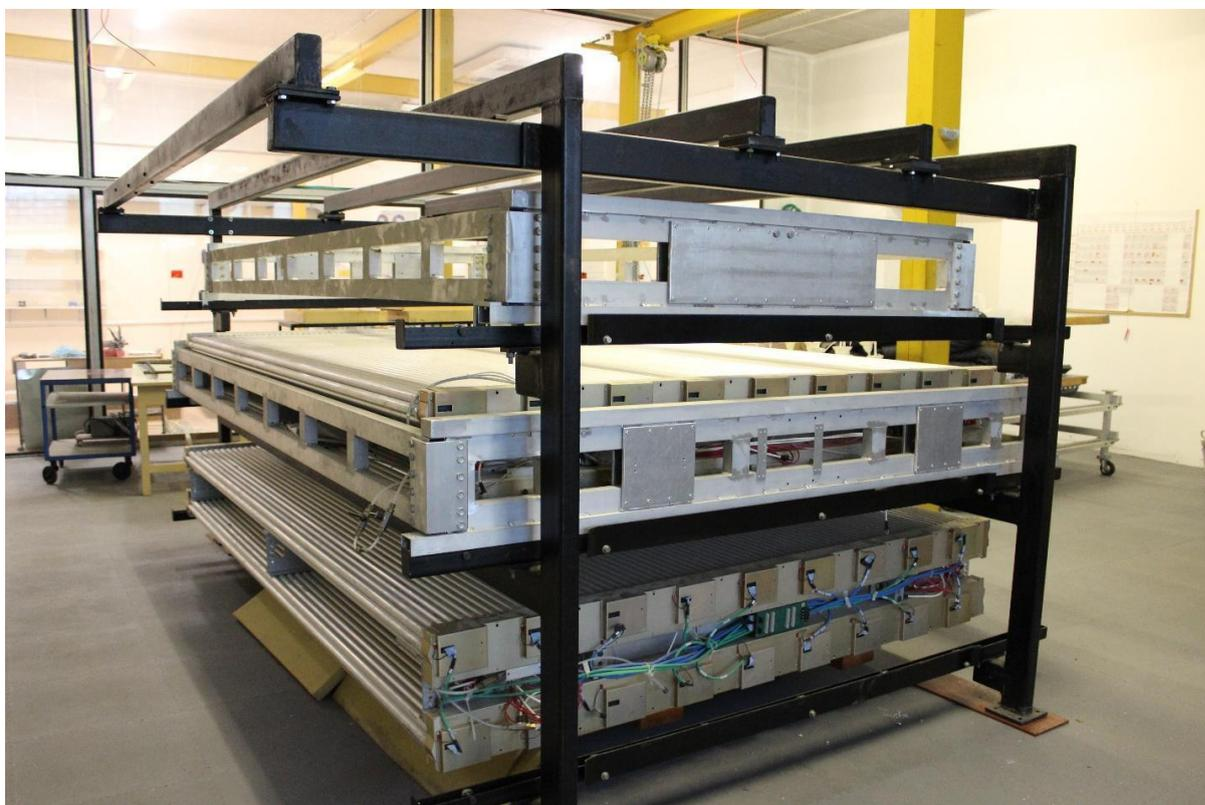
Рисунок 6 - Стенд для проверки МИК с помощью космических мюонов
