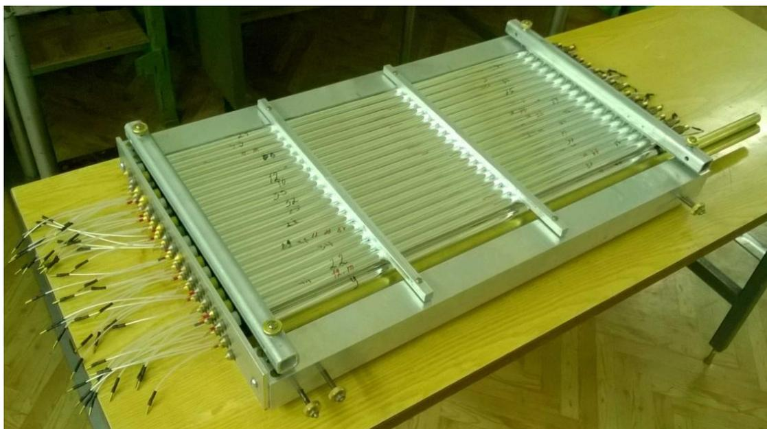
Рисунок 23 - Фотография склеенного блока дрейфовых трубок в сборочном стапеле.
