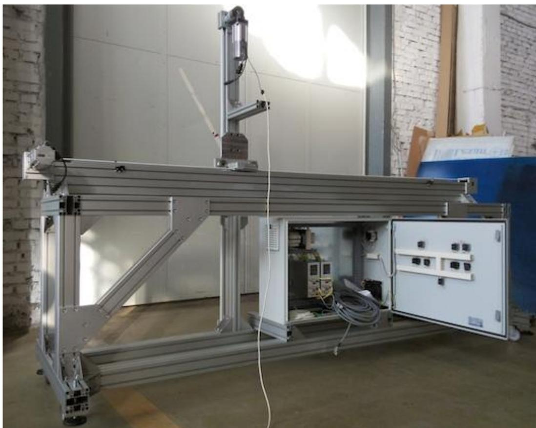
Рисунок 10 - Фотография лабораторного образца РС на раме из алюминиевого экструзионного профиля.
