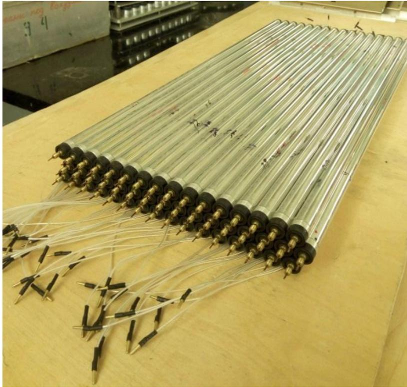
Рисунок 24 - Фотография блока дрейфовых трубок после извлечения из сборочного стапеля
