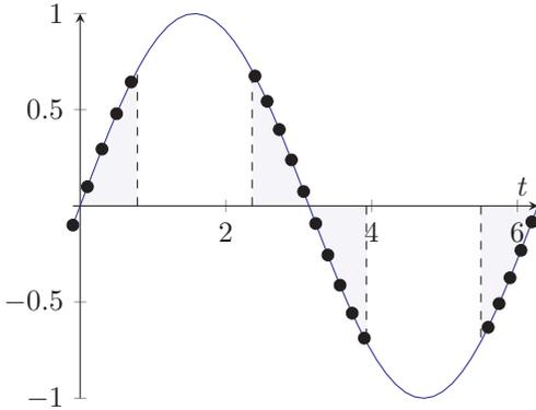
Рис. 6: Частотно-модулированная выборка: измерения делаются только в максимально информативных точках, находящихся в окрестностях узлов сигнала
