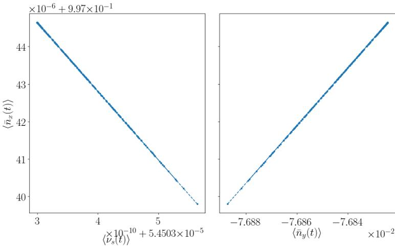
Рис. 3: Средние уровни поперечных компонент осей стабильного спина частиц, в зависимости от уровня их спин-тюна
