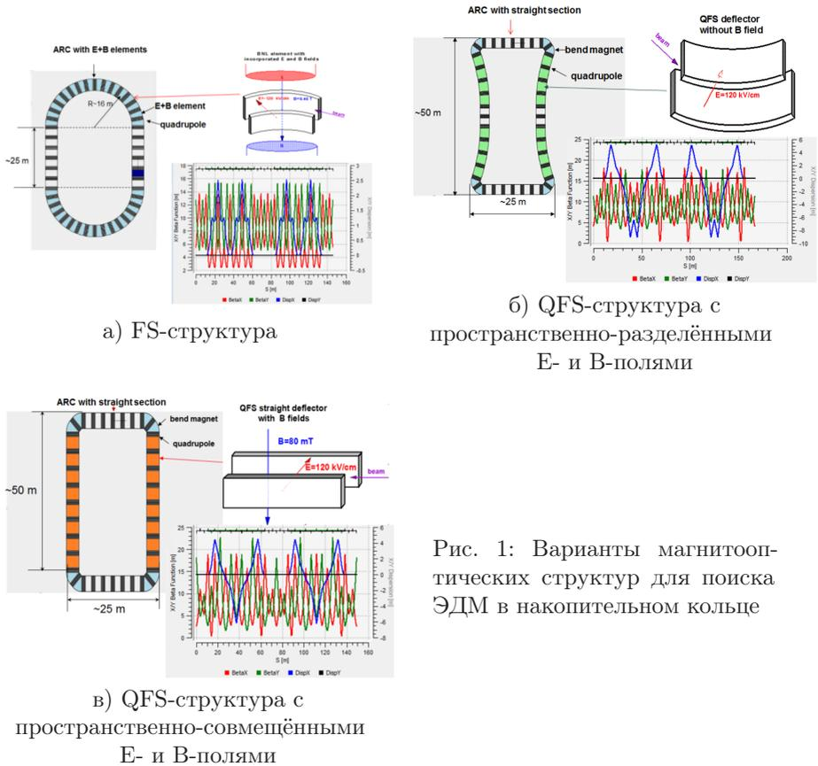
Рис. 1: Варианты магнитооптических структур для поиска ЭДМ в накопительном кольце
