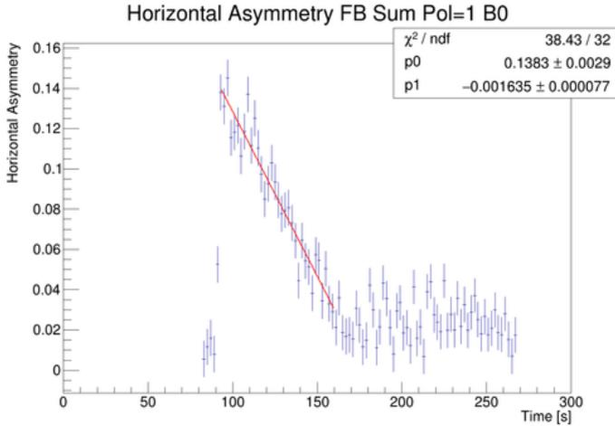
Рис. 8: Результаты измерения горизонтальной поляризации во время оптимизации времени когерентности спина при подготовке к эксперименту по поиску аксионов в апреле 2019 года
